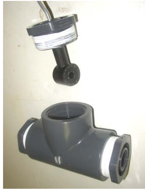
Sondă de conductivitate cu T Fig. 7
